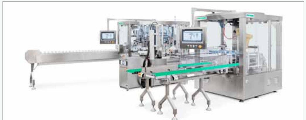
3. ábra A pneumatikával és elektronikával kombinált automatizálás biztonságos és megbízható folyamatokat biztosít, hogy a végtermék, azaz az inzulinadagoló toll szintén biztonságos és felhasználóbarát legyen (Fotó: Syntegon)
