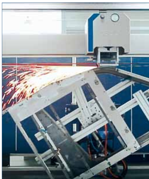
2. ábra A robotizált polírozó- és csiszológép működés közben
