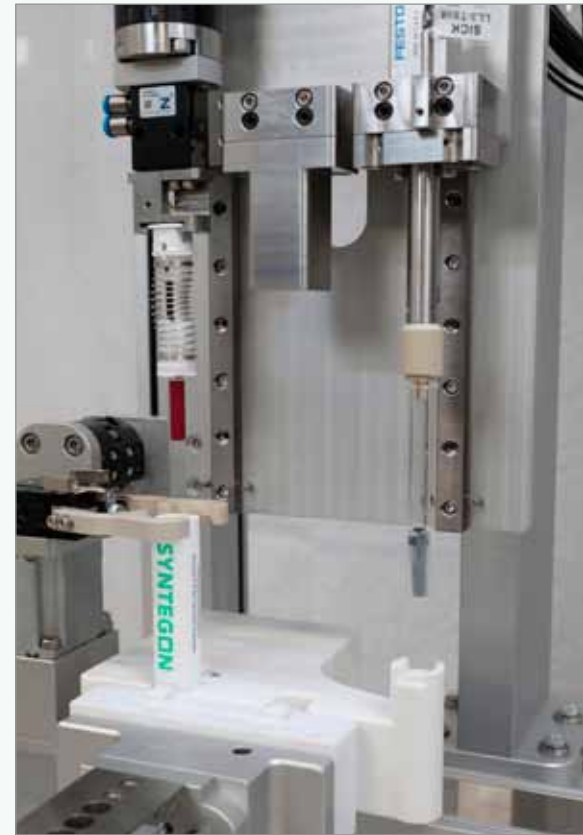
2. ábra Az YJKP szervoprés készlet három illesztő-préselő lépést hajt végre: a patron, a tű és a rugó behelyezésétől az üveg és a műanyag fedél beillesztéséig (Fotó: Syntegon)
