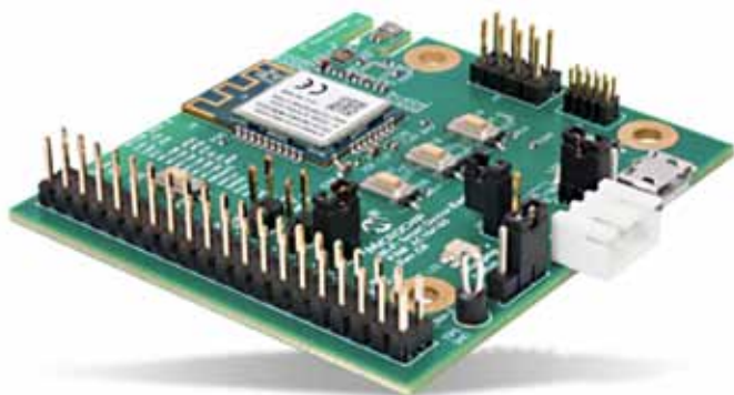
1. ábra Az AC164165 Wi-Fi okoseszköz engedélyezőkészlet (Forrás: Microchip)
