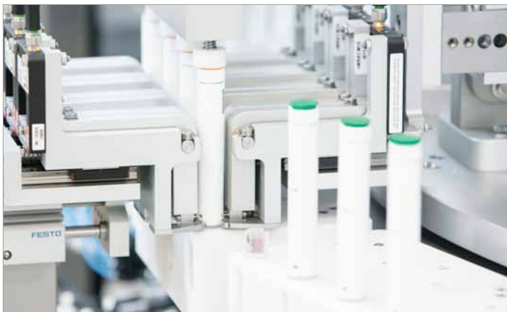
1. ábra Az új gép teljes nézete: A Syntegon automata összeszerelő gépsora a modelltől függően percnként akár 300 inzulinadagoló tollat is képesek gyártani. A berendezések automatizálási szintje az igényekhez illeszthető és később is módosítható (Fotó: Syntegon)
